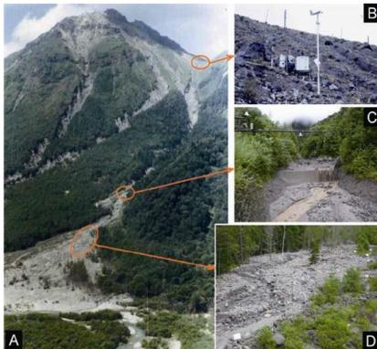
**B Pluviógrafo** sobre la zona de arranque
